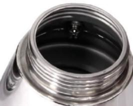
Debe llenar la cámara inferior con suficiente agua, de modo que el nivel esté justo debajo de la válvula de liberación de vapor (la tuerca de oro con un orificio en el centro). Esto es para asegurar que se pueda acumular suficiente presión para empujar el agua a través del embudo.
