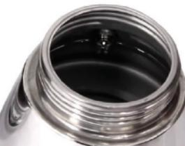
Sie müssen die untere Kammer mit genug Wasser füllen, damit sie bis knapp unter dem Abdampfventil gefüllt ist (die goldene Mutter mit einem Loch in der Mitte). Dies stellt sicher, dass sich genug Druck aufbauen kann, um das Wasser durch den Trichter zu drücken.
