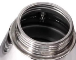
Dovrai riempire la camera inferiore a sufficienza, facendo sì che arrivi ad un livello appena sotto la valvola di rilascio del vapore (il dado dorato con foro al centro). Questo serve a far sì che si accumuli abbastanza pressione per spingere l'acqua attraverso la cannula.
