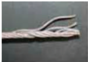
EFFILOCHAGE Câble visiblement distendu ou déroulé
