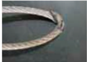
PINCEMENT L'espaces entre les fibres où le câble a été pincé.
