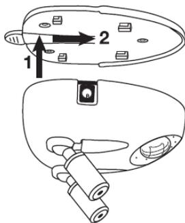
3. Monter l'unité près d'une prise électrique (en général près de celle utilisée pour l'ouverture électrique de votre porte de garage). Brancher l'adaptateur AC. La pile sert juste de secours au cas où il y a une coupure de courant et ne durera que quelques jours. Pour installer les piles de secours, enlevez la portière du compartiment de piles et insérez 3 piles AA 1.5V, en respectant la polarité +/- telle qu'indiquée dans le compartiment.
