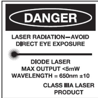
AVOID EXPOSURE, LASER RADIATION IS EMITTED FROM THE APERTURE.
